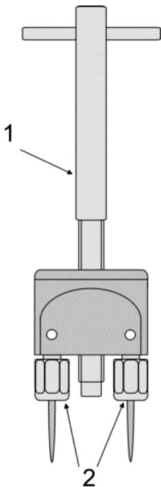
Die Nadeln in die Nadelhalter **(2)** einsetzen und mit einem Gabelschlüssel SW12mm festziehen.
